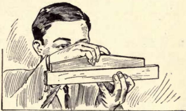
Fig. 33—Using a Wood Straightedge
