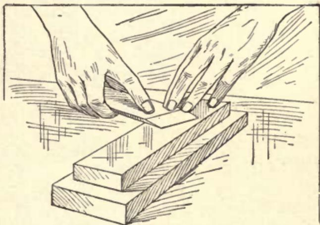
Fig. 51— Removing Wire Edge
