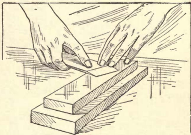
Fig. 51—Removing Wire Edge
