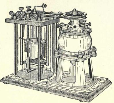
Fig. 26. Mercury Turbine Interrupter
