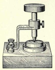
Fig. 45. Silicon Detector
