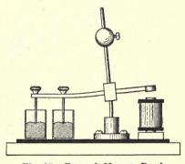
Fig. 25. Foucault Mercury Break
