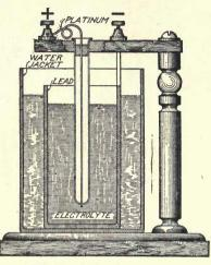
Fig. 27. Wehnelt Interrupter
