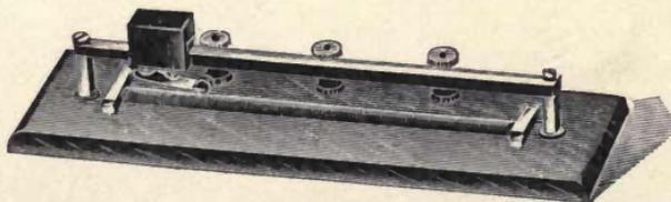
Fig. 136. Amco Potentiometer.
