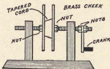
Fig. 29. Section Winder.
