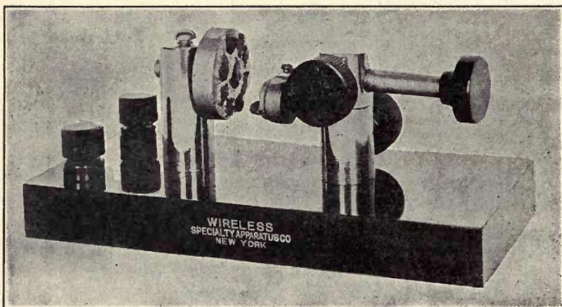
Fig. 162. Silicon Detector.
