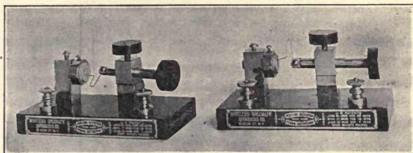
Fig. 163. Pyron Detector.
