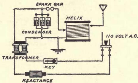
Fig. 50. Wiring Diagram.
