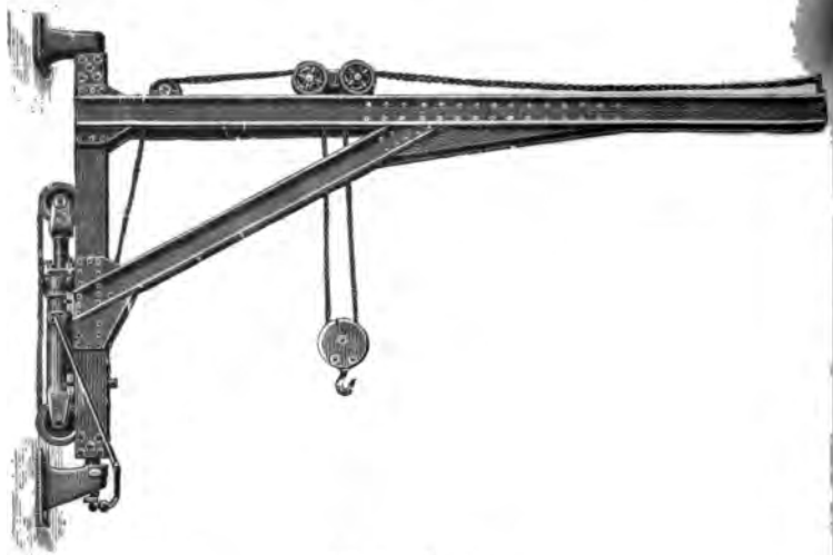
FIG. 10.—Wall Crane.
