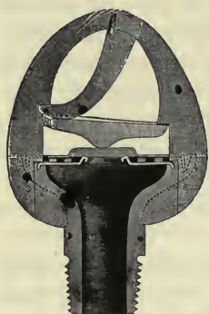
FIG. 364. — Grinnell Sprinkler.
