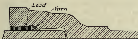
FIG. 97. — Marten Pipe-joint.
