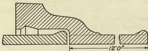
FIG. 31. — Bell-and-spigot Pipe-joint.
