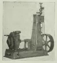
A STEAM-JACKETED CENTRIFUGAL ASPHALT PUMP.
