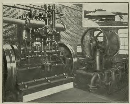
THE NASH PUMPING ENGINE, USING FUEL GAS.
