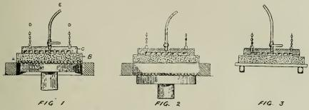
VACUUM LIFT FOR ARTIFICIAL PAVING SLABS.
