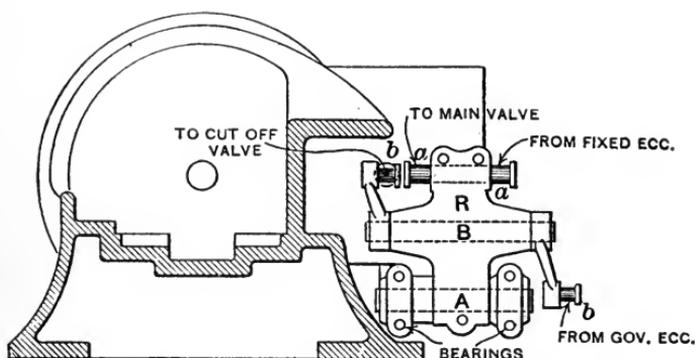
FIG. 100. — SECTION SHOWING ROCKER ARM.
