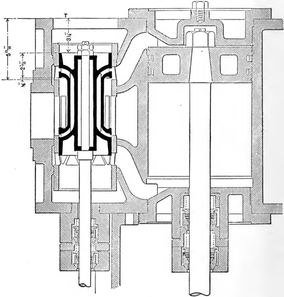
FIG. 147. — THE HIGH-PRESSURE VALVE.
