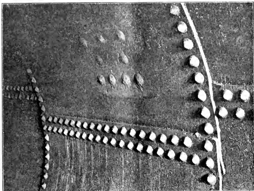
FIG. 5. SHOWING THE EVIDENCE OF DISTRESS UNDER THE LUGS AND AT THE LONGITUDINAL JOINT.
