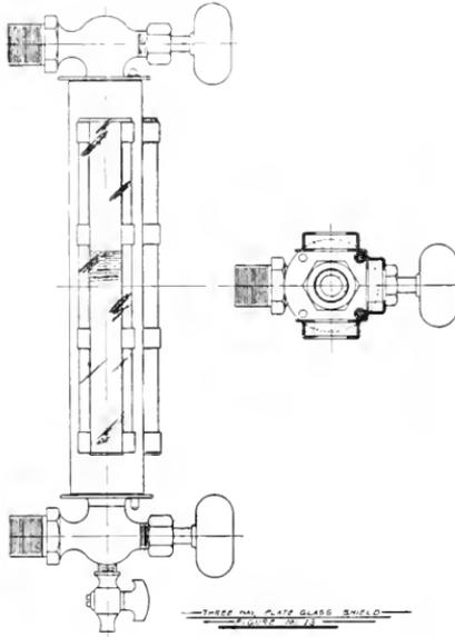
FIG. 13.— PLATE GLASS SHIELD.
