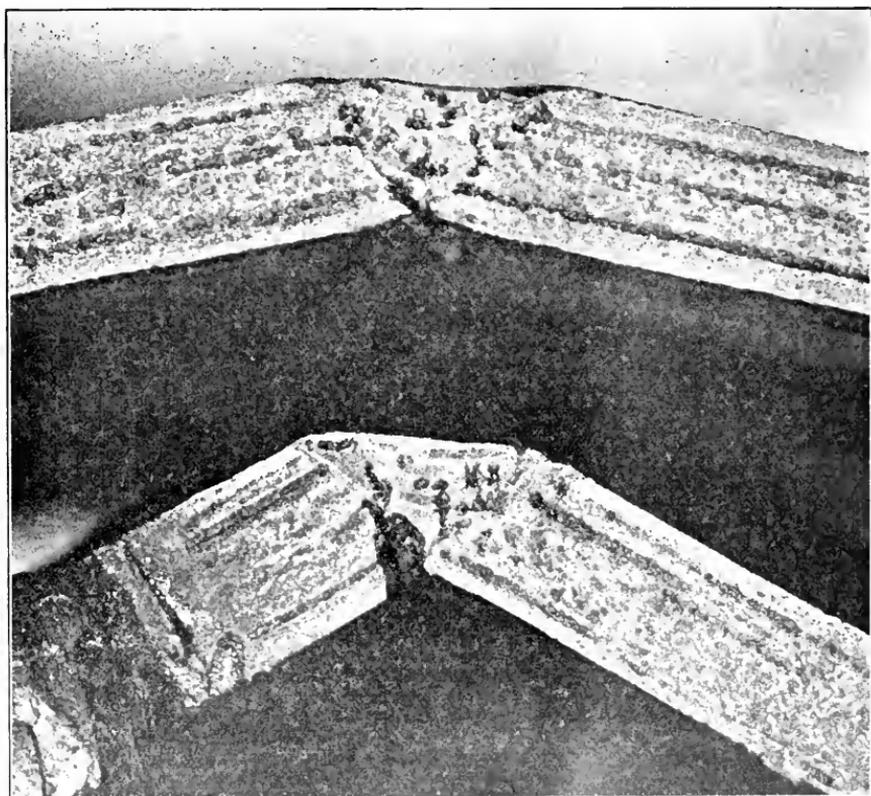
FIG. 1. (Upper.) ETCHED SECTION OF LONGITUDINAL SEAM.
