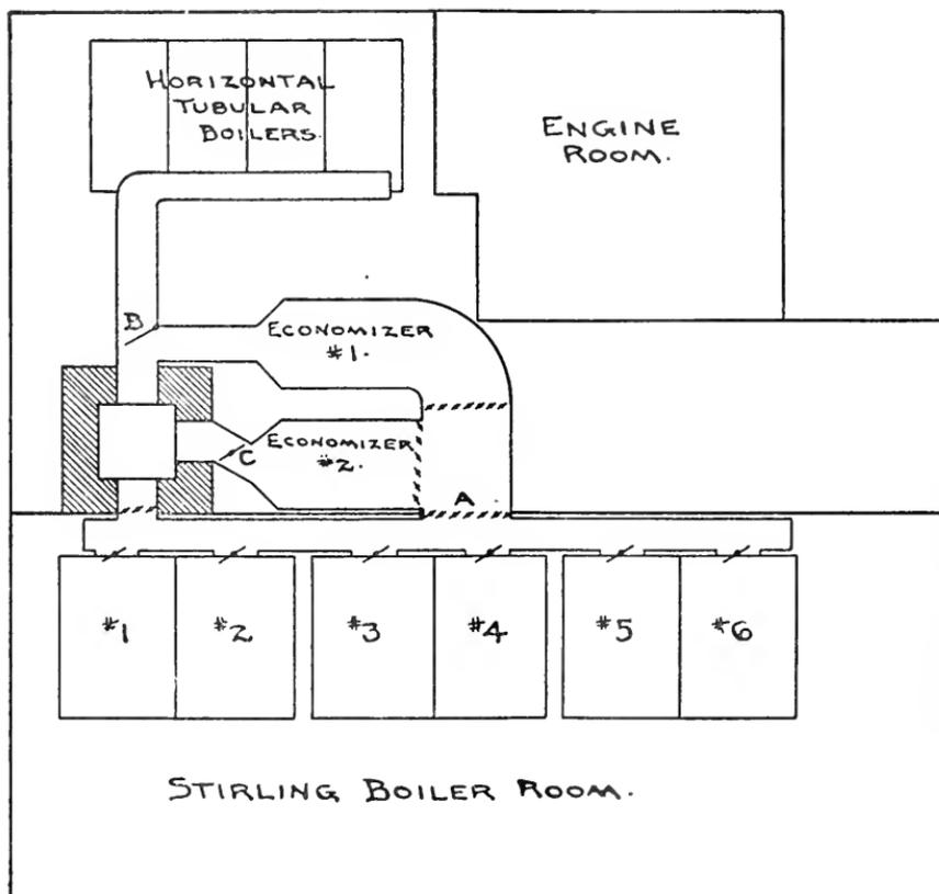
FIG. 1. PLAN SHOWING ARRANGEMENT OF BOILERS AND ECONOMIZERS.
