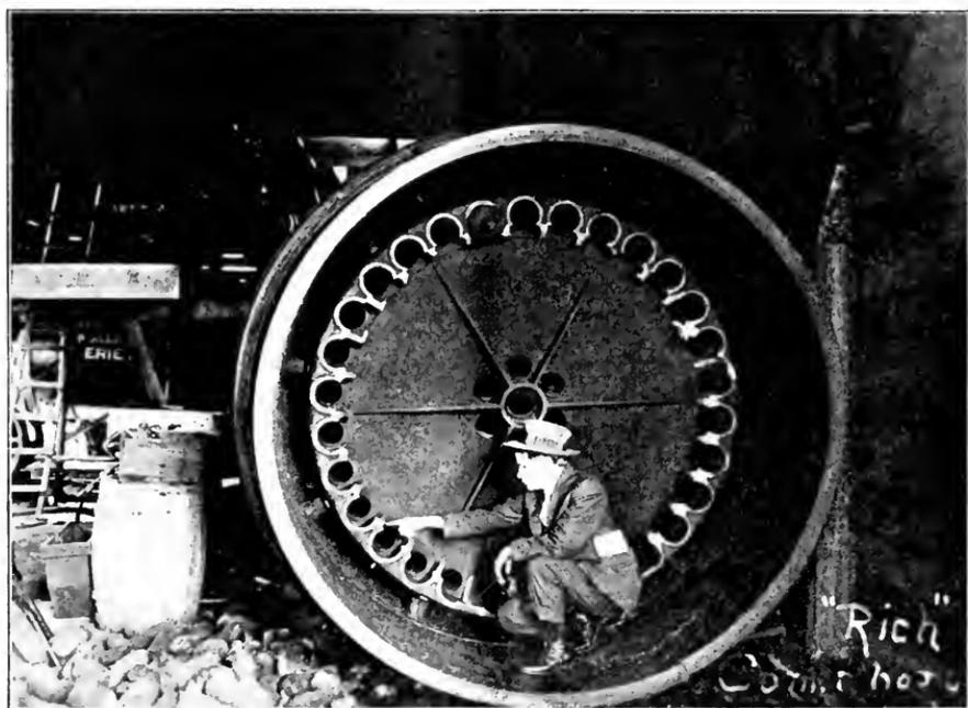
FIG. 3.—THE INSIDE OF THE EXPLODED DRYER HEAD.
