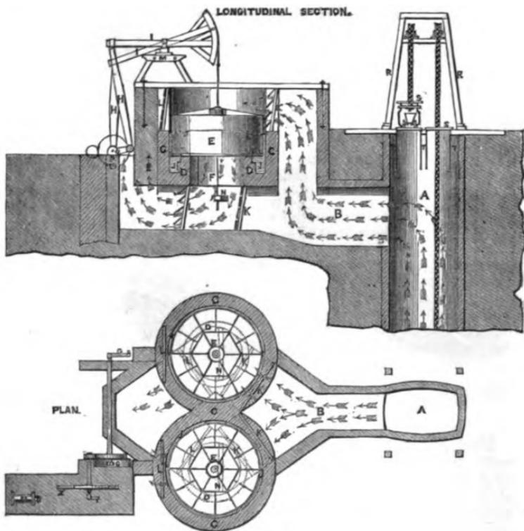
Fig. 66. Struve's Apparatus.
