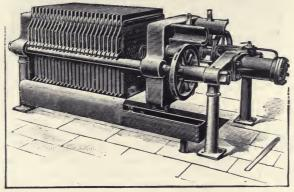
Fig. 29. Sludge Press.
