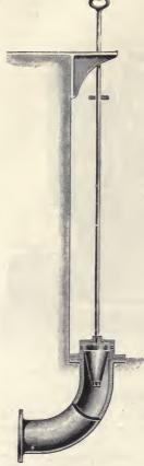
Fig. 27. Sludge Valve.
