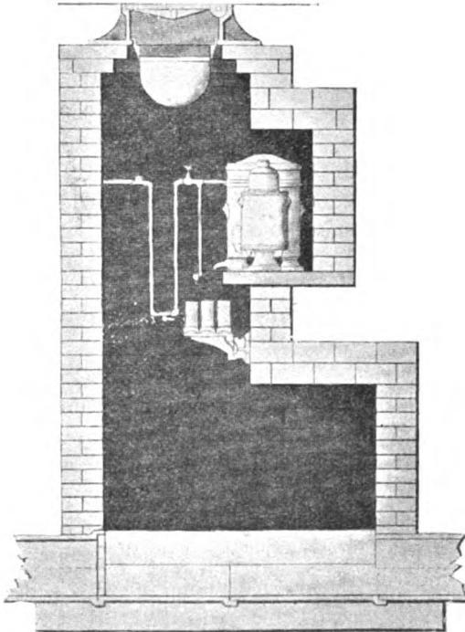
FIG. 22. REEVES' SEWER GAS DISINFECTOR.
