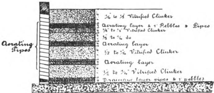
FIG. 26.—FILTERING MATERIAL.
