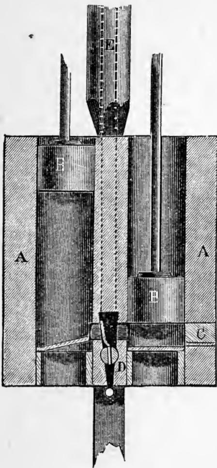
Fig. 5.—DOUBLE-ACTING FORCE PUMP.
