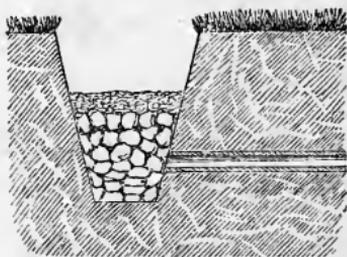
Fig. 48.—THE DRAIN AND DISCHARGE PIPE.
