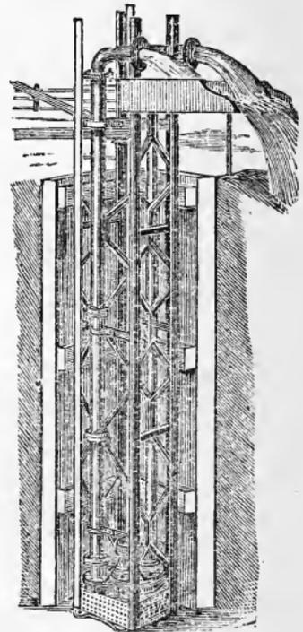
Fig. 106.—METHOD OF OPERATING A CENTRIFUGAL PUMP.
