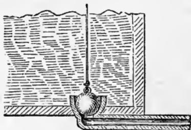
Fig. 33.—VALVE FOR DISTRIBUTING TANK.
