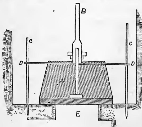
Fig. 116.—DISCHARGING PLUNGER VALVE.
