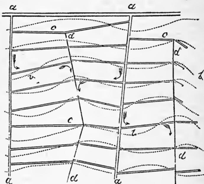
Fig. 82.—PLAN OF FURROWS FOR AN IRREGULAR SURFACE.
