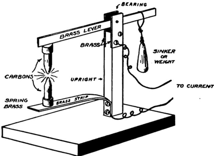
FIG. 189.—Experimental Arc Lamp.
