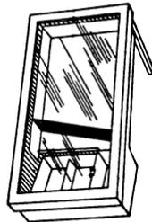
Fig. 97—Rauchfuss Solar Wax-Extractor.
