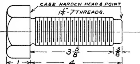
FIG. 20. ADJUSTING SCREW.
