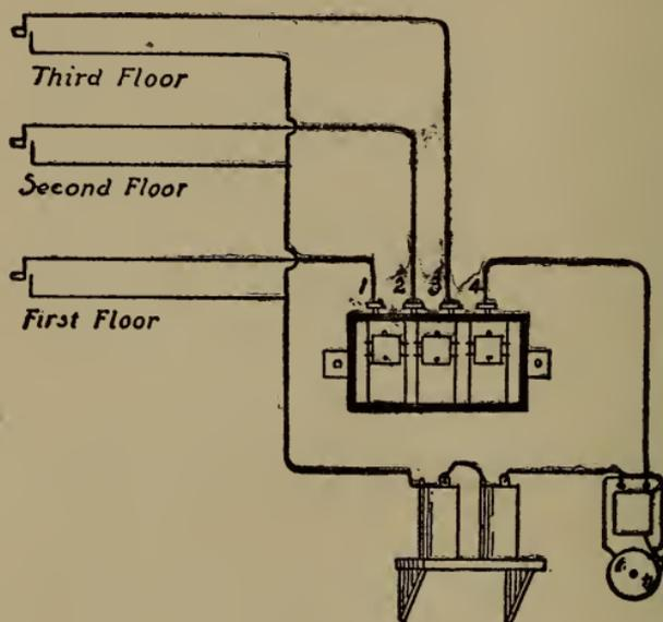
Fig. 95.—Annunciator circuit.
