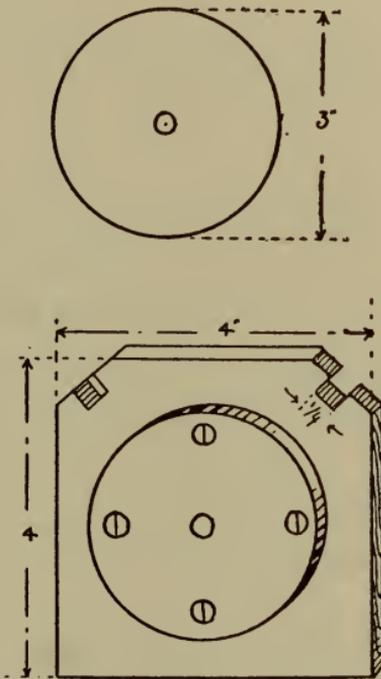
Fig. 240.—Ends for tuner.
