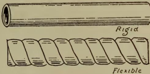
Fig. 278.—Rigid and flexible conduit.
