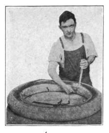
FIG. 4—CATCHING THE BEAD UNDER THE RIM; SHOWING THE MANIPULATION OF EYE-HEADED AUXILIARY LUG STEMS
