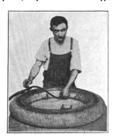
FIG. 3—INFLATING LIGHTLY BEFORE SECURING THE SHOE BEAD
