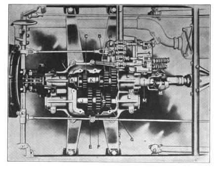
FIG. 3—SHOWING THE TRANSMISSION GEARS OF THE CADILLAC FOUR-CYLINDER CAR
