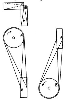
FIG. 6—FOR PULLEYS RUNNING AT RIGHT ANGLES TO EACH OTHER
