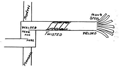
FIG. 1-HOW THE DAMASCUS TWIST IS MADE
