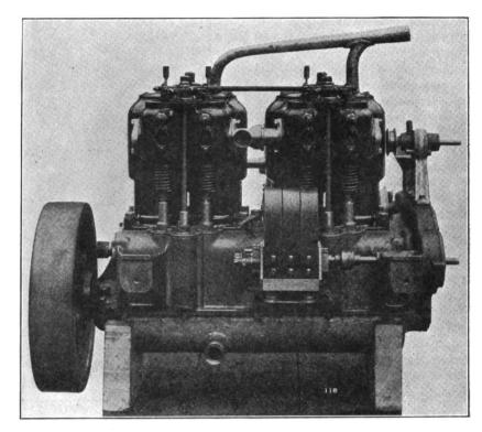
FIG. 2. THE INTAKE SIDE OF THE PREMIER ENGINE
