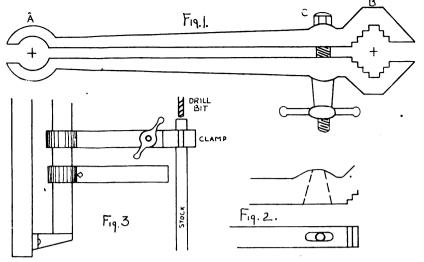
FOR HOLDING ROUND STOCK UNDER THE DRILL PRESS
