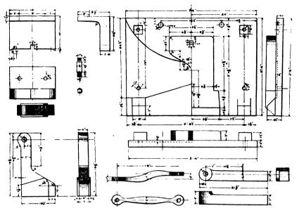
FIG. 7-A FORMER FOR BENDING BRAKE BEAM SAFETY HANGERS
