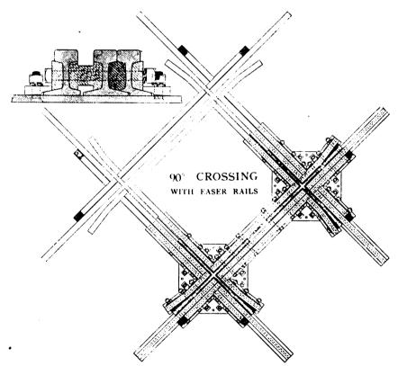
FIG. 9.—THE FILLING IS ROLLED STEEL, AS THE FLANGES ARE STRAIGHT
