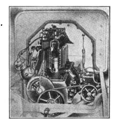
FIG. 1—THE CADILLAC MOTOR FROM THE FRONT
