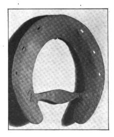
THE SHOE SHOULD BE DISHED SO THAT THE STRAIN WILL NOT COME ON THE LAMINAE
