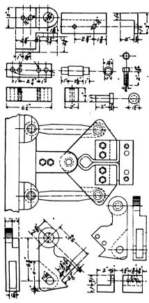
FIG. 5—FOR BENDING BRAKE SHAFT BRACKETS
