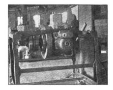
FIG. 7—A SPECIAL FRAME FOR HOLDING MOTOR
