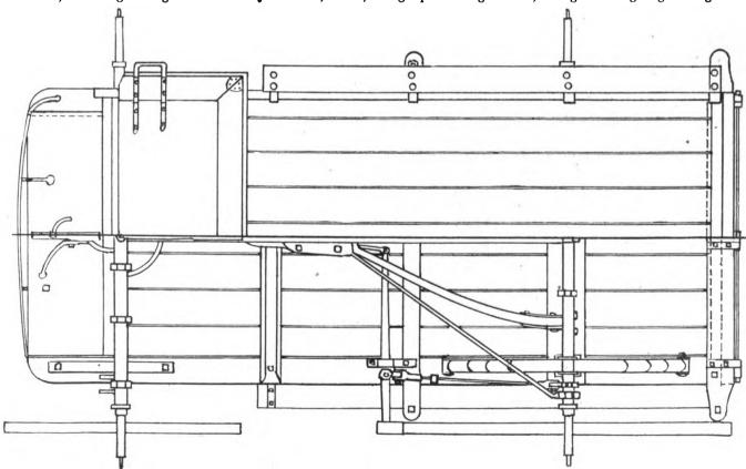
FIG. 2-HALF TOP AND HALF BOTTOM VIEWS OF THE LIGHT DELIVERY WAGON
