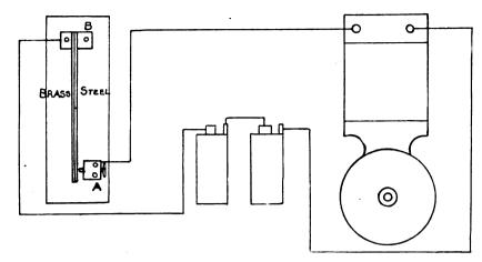
AN AUTOMATIC FIRE ALARM EASILY MADE
