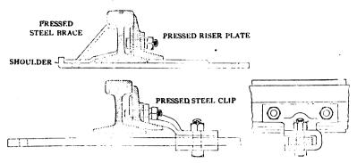
FIG. 1.—SPECIAL REINFORCED SWITCH
