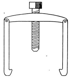
A WHEEL PULLER IS EASILY MADE
