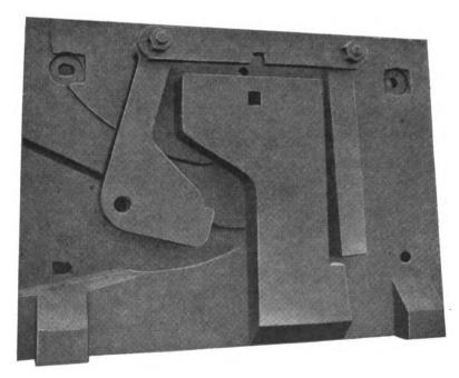
FIG. 2. BRAKE BEAM SAFETY HANGERS ARE BENT INTO SHAPE
