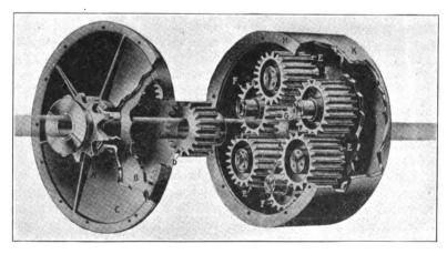
FIG. 6.—GEAR CASE SHOWING GEARS OF PLANETARY TRANSMISSION
