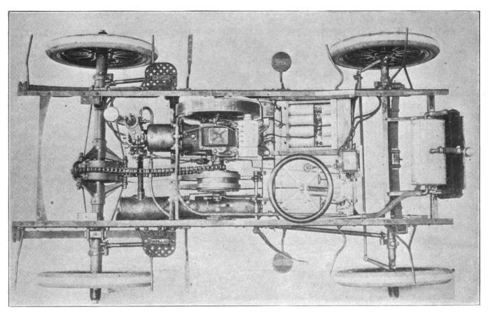
FIG. 1.—THE CADILLAC SINGLE-CYLINDER CHASSIS FROM ABOVE
