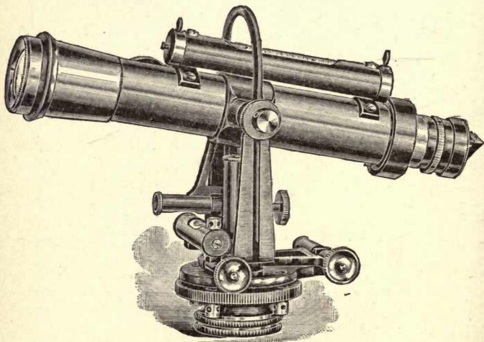
FIG. 24. THE SAEGMULLER SOLAR ATTACHMENT.
