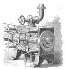
Fig. 98.—Corliss Engine Valve-Motion,
