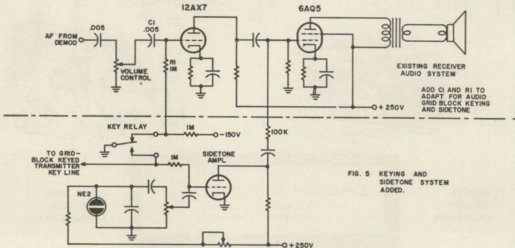
FIG. 5 KEYING AND SIDETONE SYSTEM ADDED.
