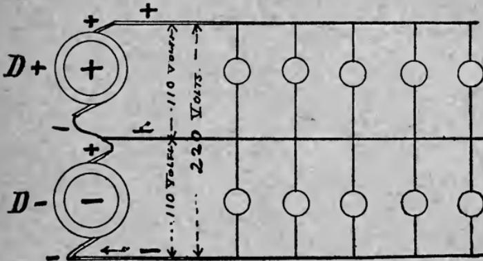
FIGURE 23.—EDISON 3 WIRE SYSTEM SUPPLYING 10 LAMPS.
