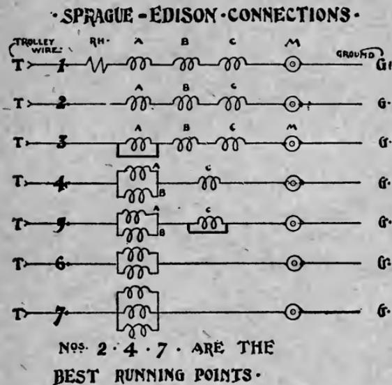
FIGURE 35.—SPRAGUE-EDISON STREET CAR MOTOR CONNECTIONS.
