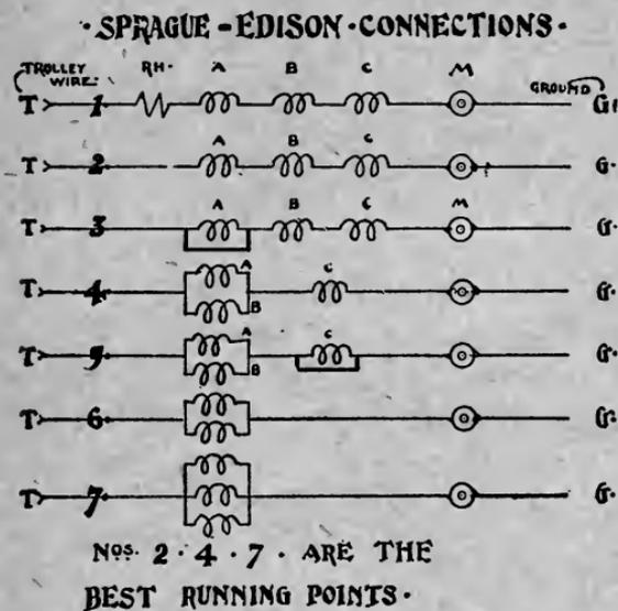
FIGURE 35.—SPRAGUE-EDISON STREET CAR MOTOR CONNECTIONS.
