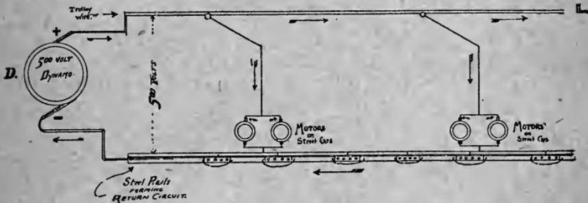
FIGURE 24 —STREET RAILWAY TROLLEY SYSTEM.
