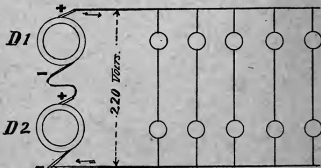
FIGURE 22.—MULTIPLE SERIES SYSTEM FOR 10 LAMPS.
