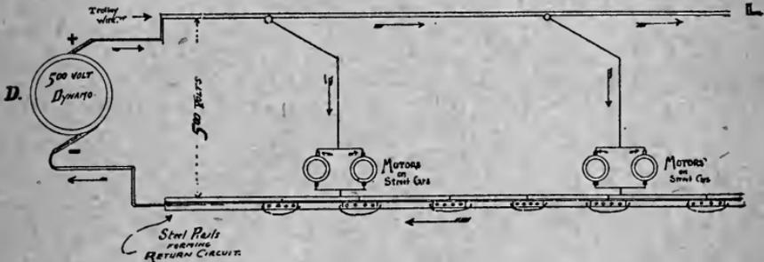
FIGURE 24 —STREET RAILWAY TROLLEY SYSTEM.
