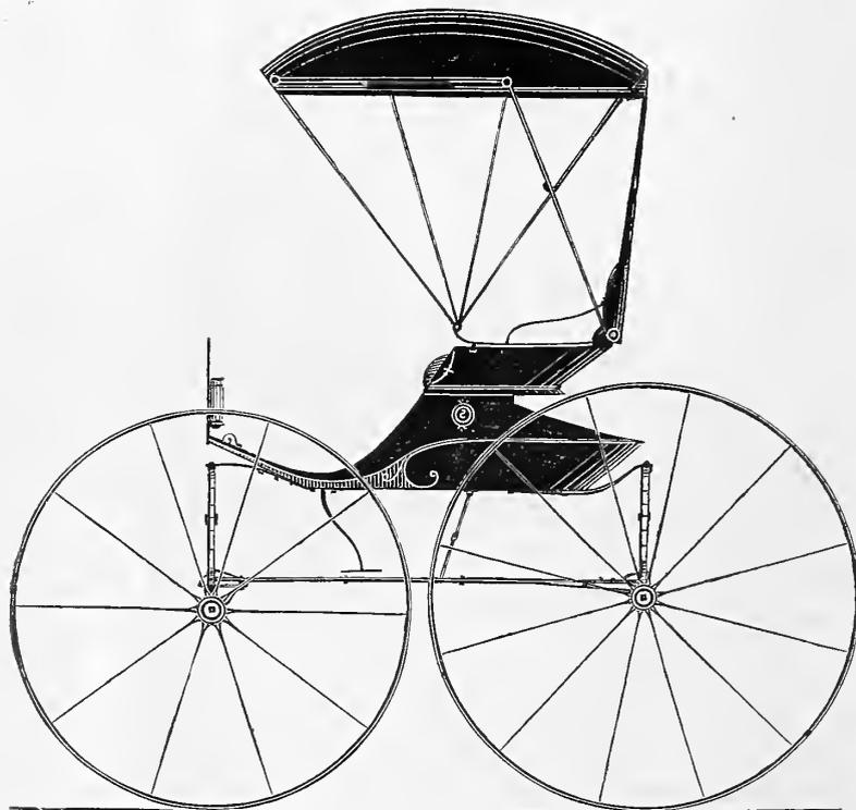
SHIFTING-TOP SCROLL COAL-BOX BUGGY. — $\frac{1}{2}$  IN. SCALE.
