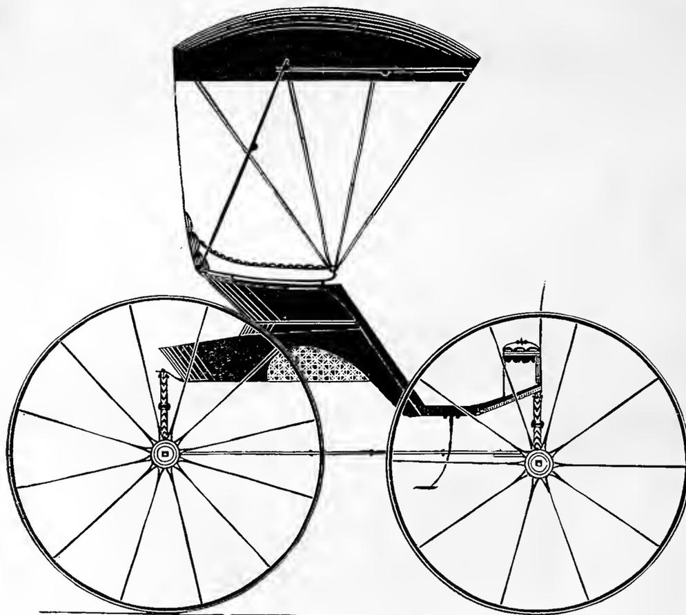
DROP-FRONT EXTRA-SEATED COAL-BOX BUGGY.— $\frac{1}{2}$  IN. SCALE.
