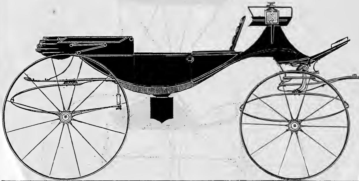
CALECHE ON PLATFORM AND ELLIPTIC SPRINGS.— $\frac{1}{2}$  IN. SCALE.
