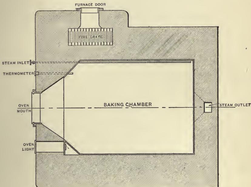
Fig. 214.—“Viennara” Patent Steam-pipe Oven : Sectional Plan
