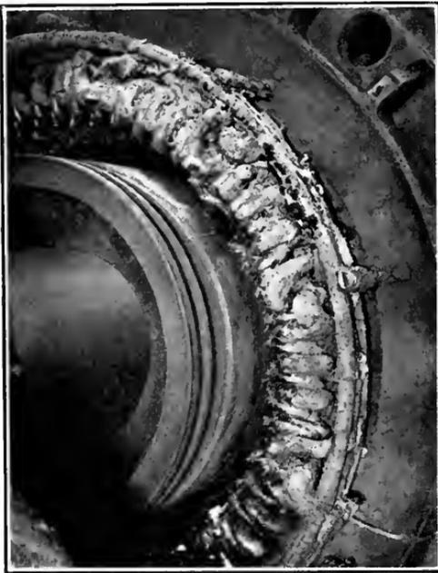
FAILURE OF LARGE TURBO-GENERATOR.
