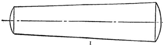
FIG. 1. — SIMPLE TAPER PLUG.
