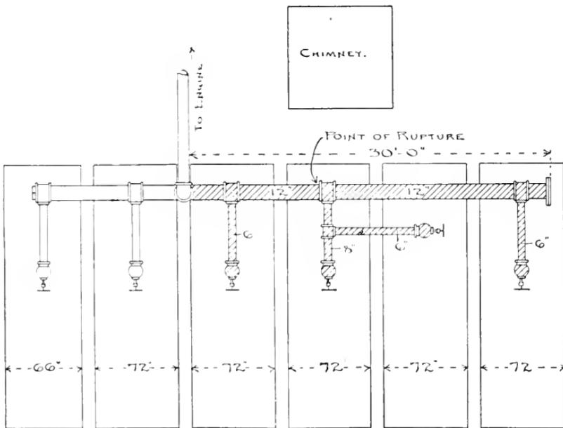
FIG. 1. — PLAN VIEW OF BOILER PLANT.
