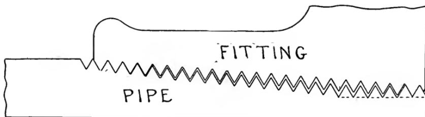
FIG. 15. — ILLUSTRATING AN IMPERFECT PIPE JOINT.
