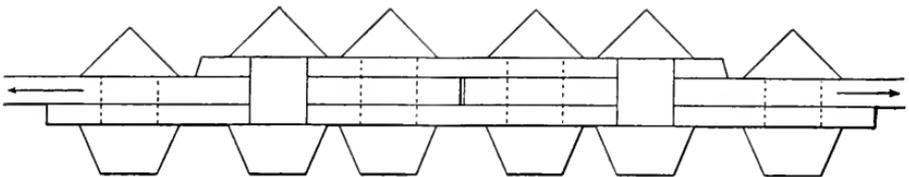
FIG. 8. — DOUBLE-STRAP BUTT JOINT.
