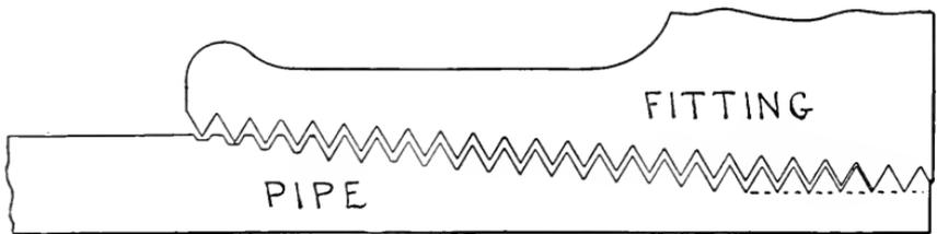
FIG. 14. — ILLUSTRATING AN IMPERFECT PIPE JOINT.
