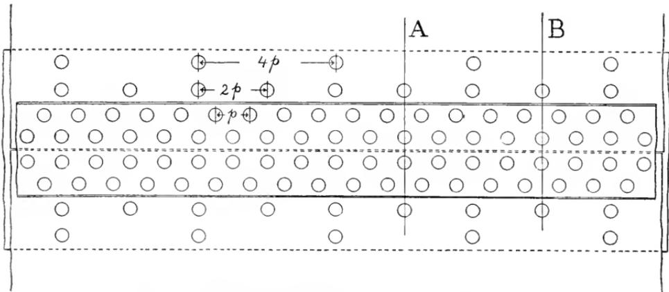
FIG. 1—QUADRUPLE-RIVETED BUTT STRAP JOINT.
