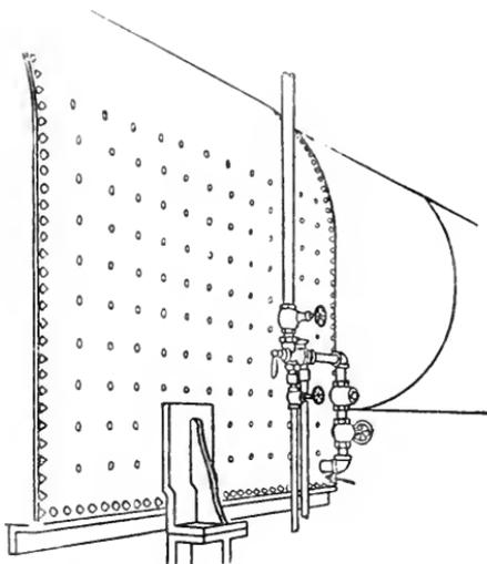
FIG. 1.—SHOWING THE LOCATION OF THE FEED PIPE.
