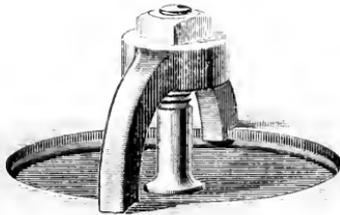
FIG. 1. — COMMON TWO-LEGGED GUARD.
