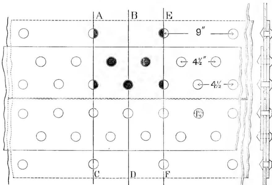
A TRIPLE-RIVETED BUTT-STRAP JOINT.
