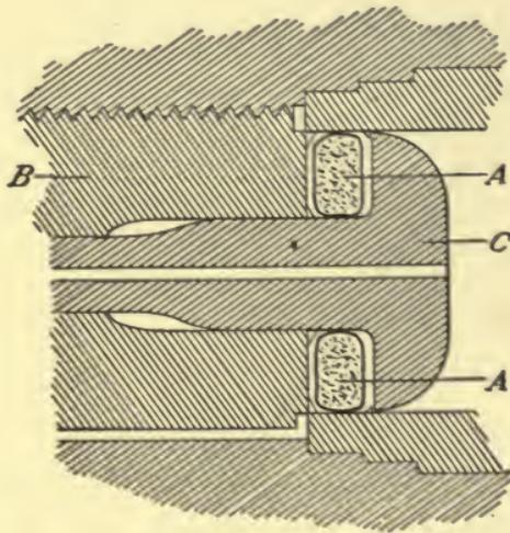
FIG. 36.—THE DE BANGE GAS STOPPER
