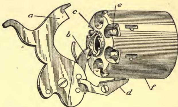
FIG. 82.—MECHANISM OF THE ORIGINAL COLT REVOLVER
