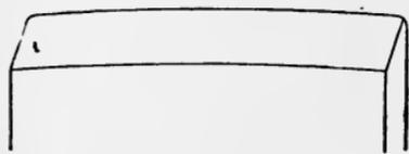
Fig. 11.—Curve of Jack Plane Iron.
