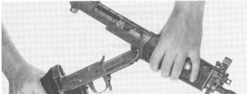
Anbringen des Abzuggehäuses, Bild A
