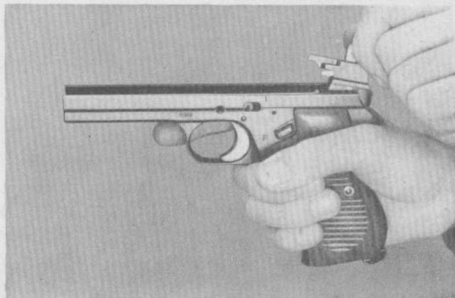
Die Schliessfederstange aus dem Lauf und dem Verschlussstück herausnehmen.
