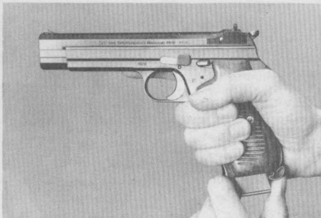
Mit der rechten Hand die Waffe am Griffstück halten; mit der linken Hand das Verschlussstück soweit zurückstossen bis die Strichmarken am Verschlussstück und am Griffstück übereinstimmen. Gleichzeitig mit dem Zeigefinger der rechten Hand auf das Ende des Verschlusshalterstiftes drücken. Mit der linken Hand Verschlusshalter ganz herausziehen.
