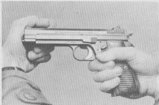
Das ganze Verschlussstück mit Lauf und Schliessfederstange nach vorn herausziehen.
