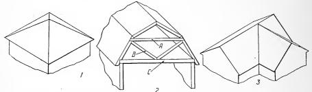
FIG. 152.-ROOF FORMS. (1) HIP ROOF; (2) GAMBREL; (3) GABLE.
