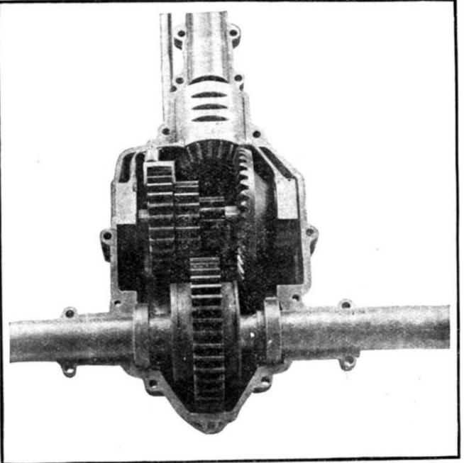
**THE CAMERON—A UNIQUE SLIDING GEAR TRANSMISSION.**
