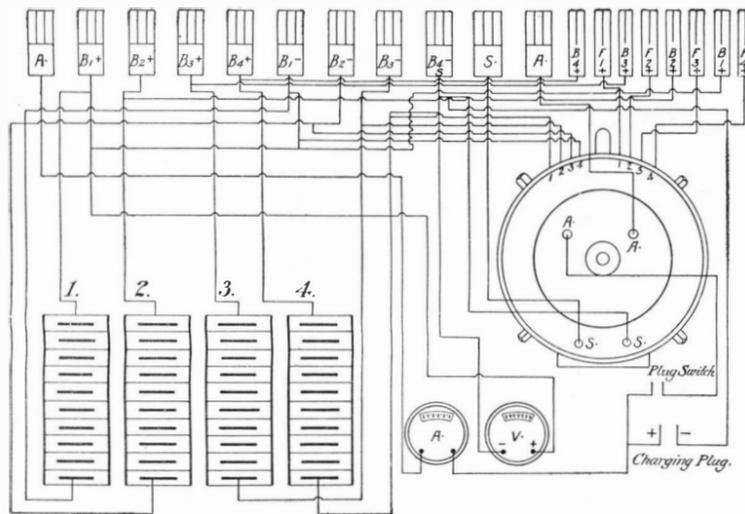
DIAGRAM OF CONTROLLER CIRCUITS OF RECHARGING MOTOR.
