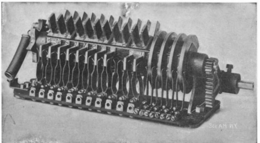
CONTROLLER FOR A RECHARGING MOTOR.
