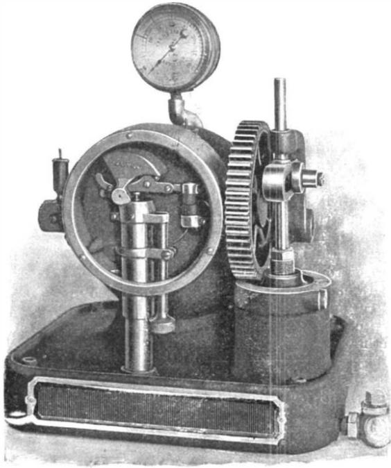
**ELECTRIC DRIVEN AIR-PUMP FOR LIGHT SERVICE.**
