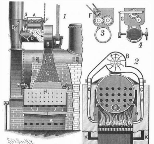
AUTOMATIC FEEDING SYSTEM FOR BOILER FURNACES.
