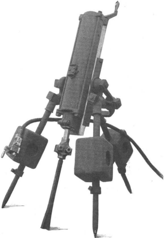
Fig. 1.—THE MARVIN ELECTRIC ROCK DRILL.
