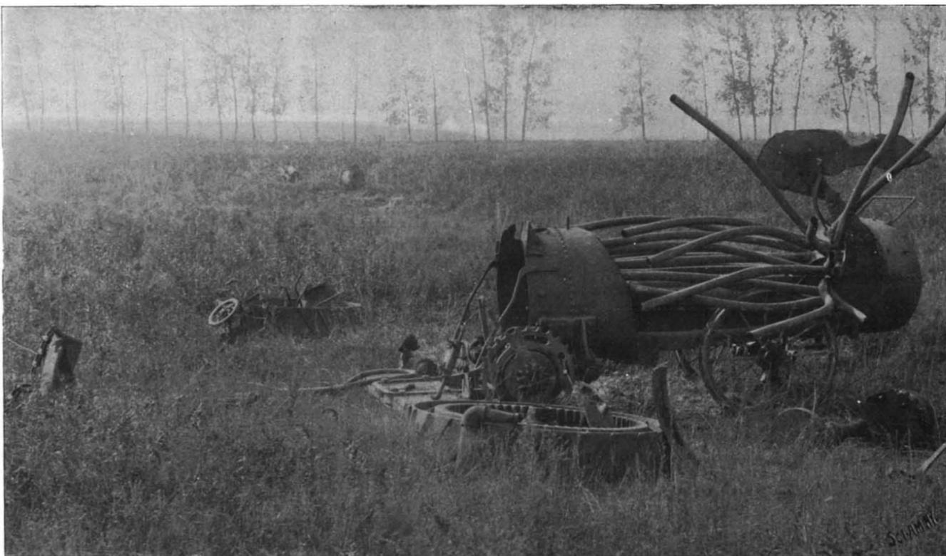
A TRACTION ENGINE BOILER EXPLOSION.
