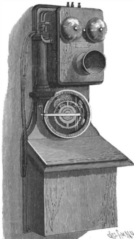
Fig. 1.—THE HOUTS TELEPHONE—AUTOMATIC CALL FOR SIXTY SUBSCRIBERS.
