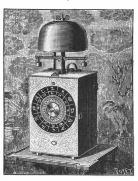
Fig. 2.-JAPANESE CLOCK WITH WEIGHTED BALANCE.
