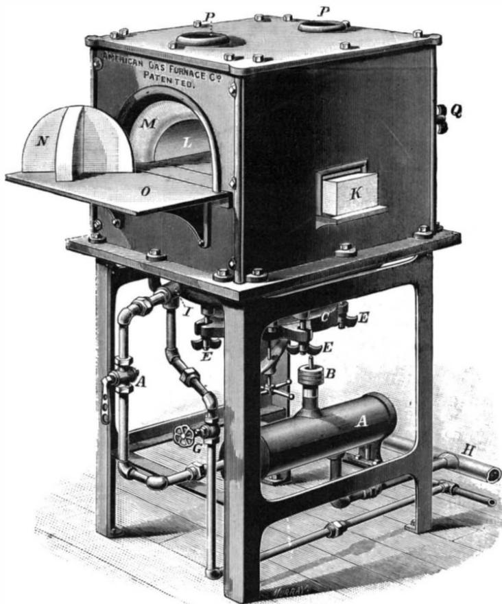
Fig. 12.—MUFFLE FURNACE.
