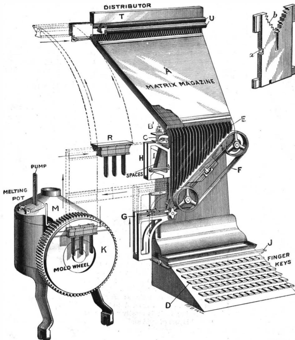
THE LINO TYPE-DIAGRAM SHOWING OPERATION OF MACHINE.
