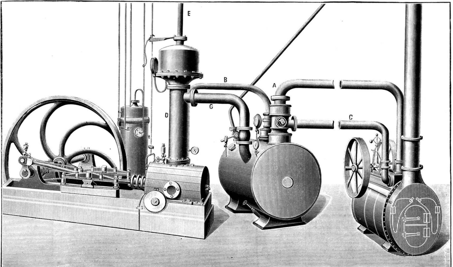
Fig. 3.—GENERAL VIEW OF THE ETHER MOTOR OPERATING WITH THE LIVE STEAM OF A MOVABLE ENGINE.
