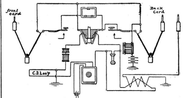
Fig. 6.—KEYBOARD CONNECTIONS.
