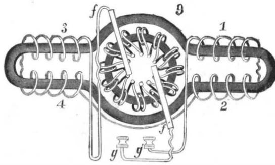
Fig. 9.—CIRCUIT OF SIMPLE ELECTRIC MOTOR.
