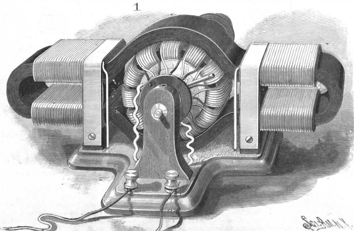
Fig. 1.—SIMPLE ELECTRIC MOTOR (ABOUT HALF SIZE).
