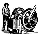
ROCK BREAKERS AND ORE CRUSHERS.
